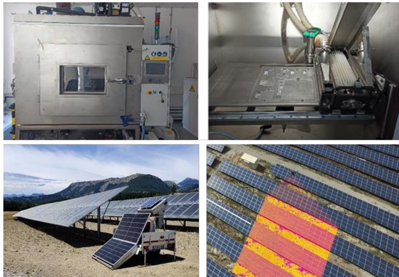
**Fig. 3:** Ci-dessus : Les enceintes/laboratoires d'essais d'encrassement PV du CEA. En bas : Le kit d'essais d'encrassement du CEA pour les mesures en extérieur et le diagnostic PV du CEA basée sur l'imagerie IR.
